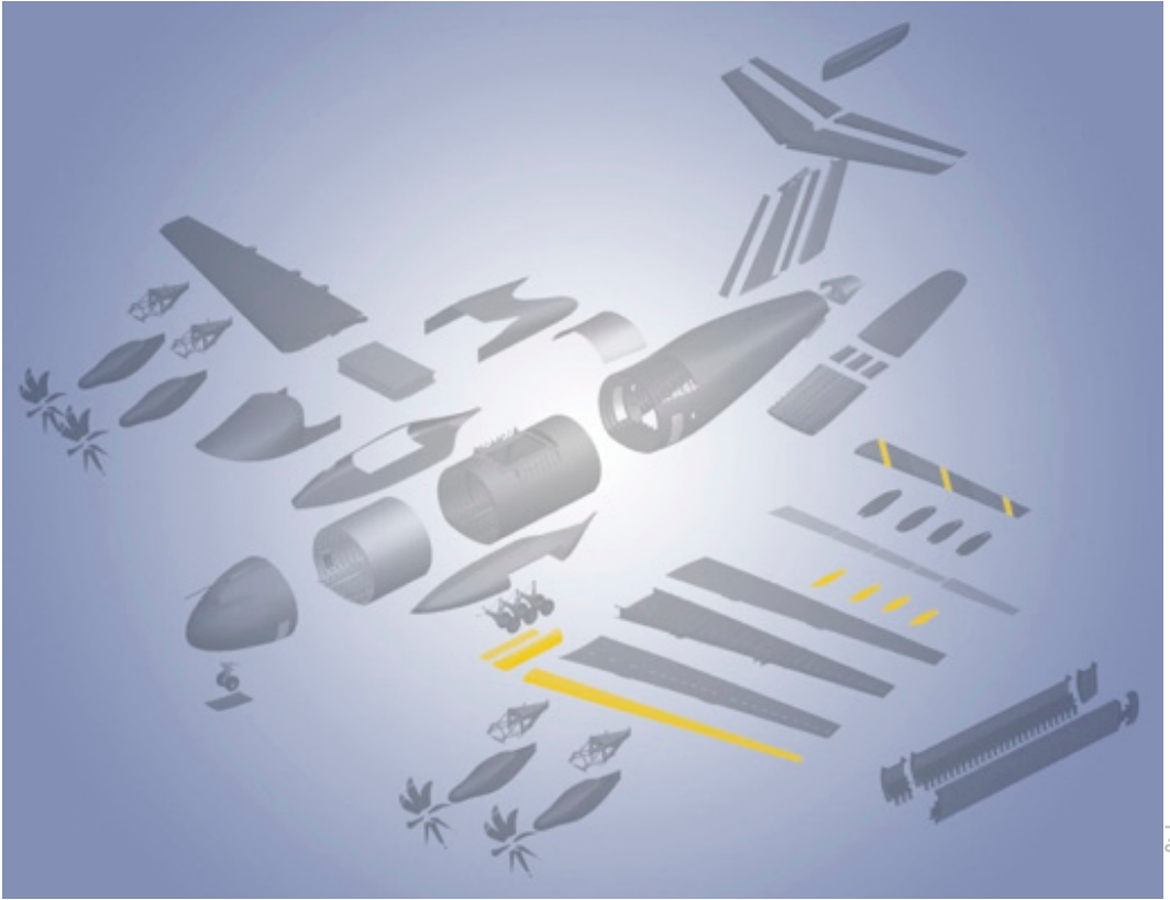
A400M - de work-share voor Belgische bedrijven: deuren van het landingsgestel, aanvalsboorden en flaps support -mechanismen.
