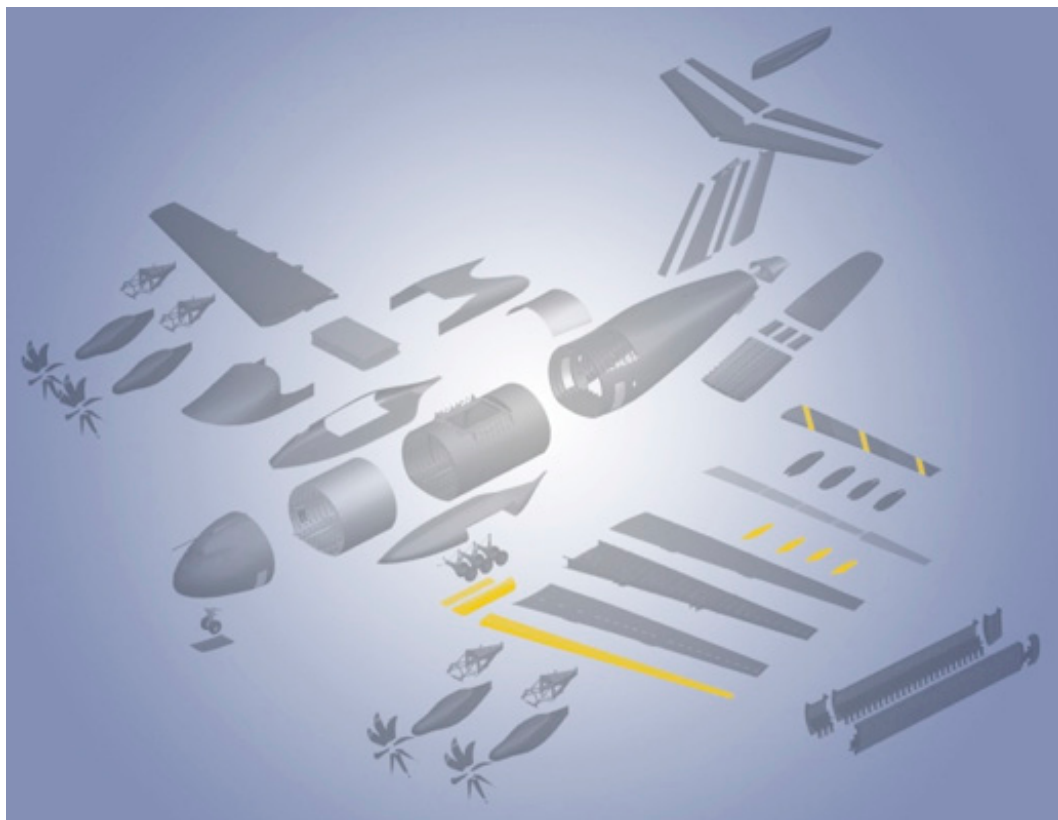
A400M - Le work-share pour les entreprises belges : portes du train d'atterrissage, bords d'attaque et mécanismes de support des flaps.
